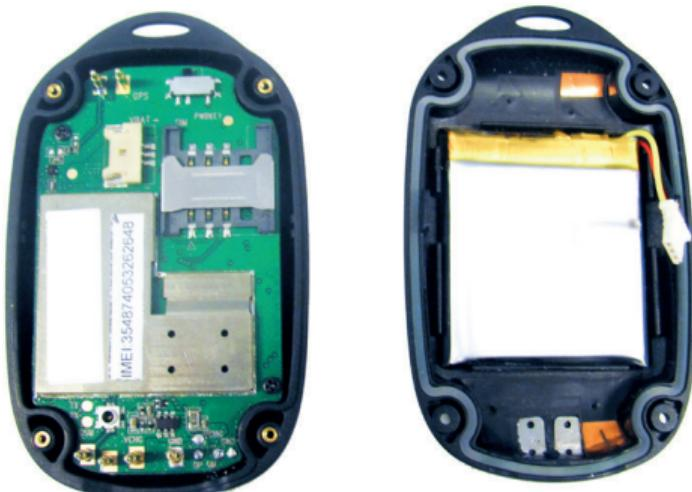
Het toestel wordt geleverd met losse schroeven zodat u de benodigde SIM-kaart zonder openschroeven kan installeren. Let erop dat de SIM-kaart geen PIN-code ingesteld heeft.
