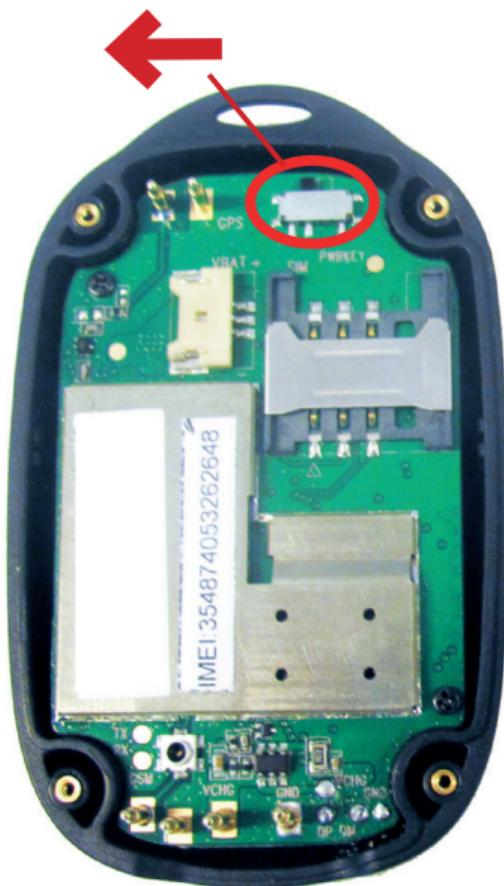
4. Legen Sie die beiden Hälften nebeneinander und stellen Sie sicher, dass der Akkudraht nicht dazwischen eingeklemmt wird. Drücken Sie die beiden Hälften zusammen, bis Sie ein Klicken hören.
