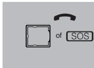
Lassen Sie den Hörer auf dem Telefon und drücken Sie eine Foto- oder die SOS-Taste, die Lautsprecherfunktion schaltet sich ein und die Nummer wird gewählt.
