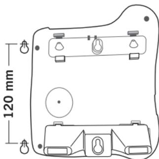
2. Haken Sie das Telefon mit den Schraubklammern an den Schrauben ein und drücken Sie das Telefon nach unten.
