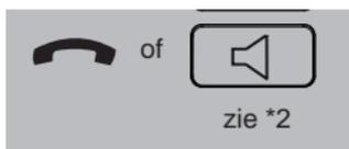
leg de hoorn neer of druk op de luidsprekertoets om de verbinding te verbreken
