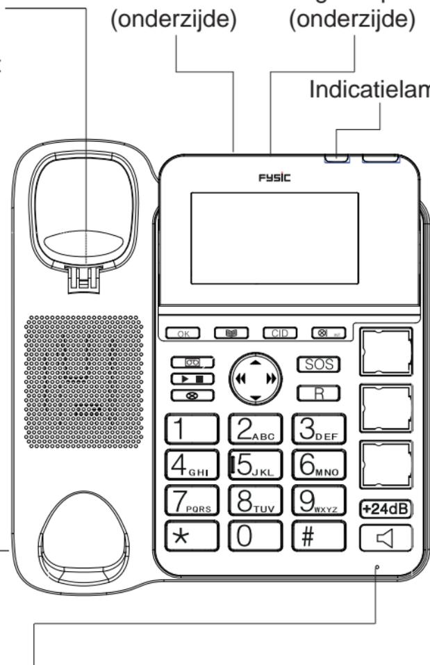
Ingebouwde microfoon, wordt gebruikt bij het handenvrij telefoneren en bij het inspreken van de meldtekst bij de beantwoorder
