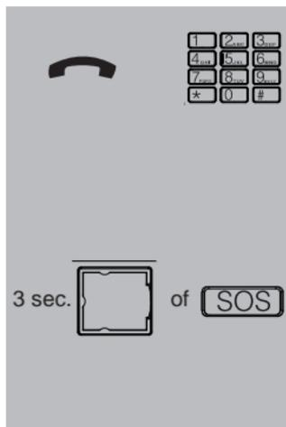
laissez le cornet raccroché et insérez le numéro de téléphone via le clavier (20 chiffres max.)
