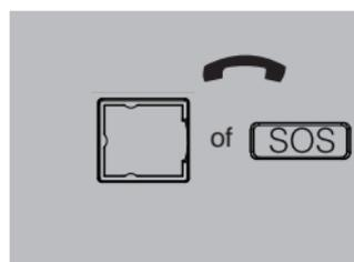
laat de hoorn op de telefoon liggen en druk op een fototoets of SOS, de luidsprekerfunctie wordt ingeschakeld en het nummer wordt gekozen
